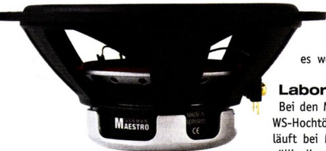
Die Zentrierspinne ist über einen gelochten Haltering belüftet. Die Metallkappe um den Magnet dient als Kühlkörper
